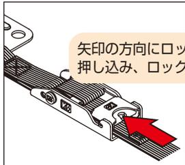
矢印の方向にロック板を押し込み、ロックを解除。
