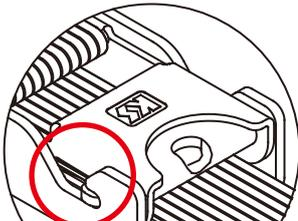
ロック板の爪がバックル底の溝に入っていることを確認。最後にベルトに弛みが無いが、足場板が外れないかを確認します。
