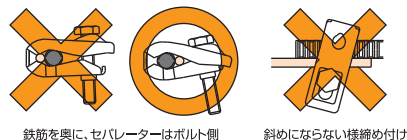
鉄筋を奥に、セパレーターはボルト側
